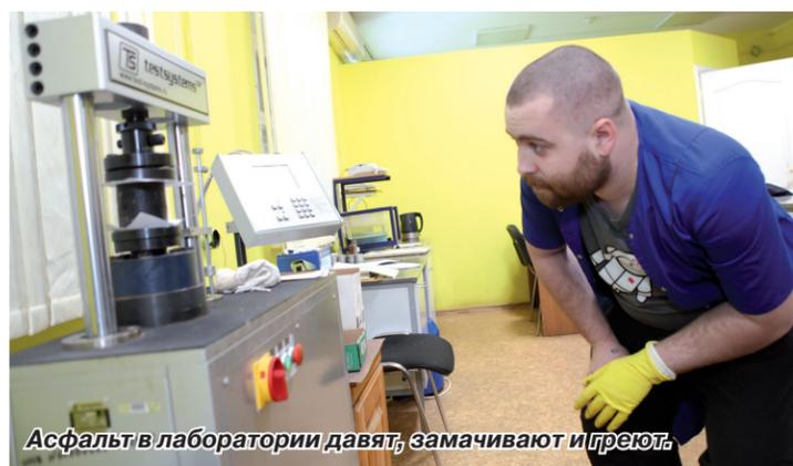
Асфальт в лаборатории давят, замачивают и греют.
